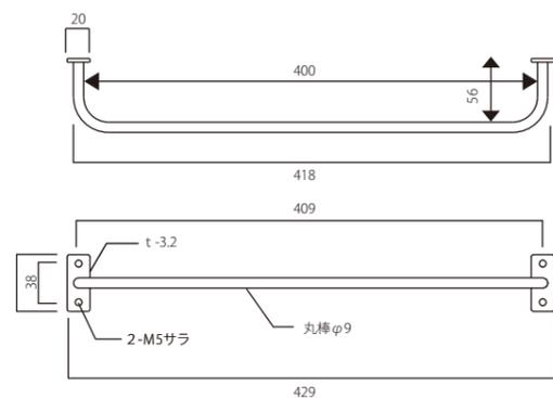
組み立て式のタオルバーです。ブラケットの位置を自由に設定できるため微調整が必要なタイルの目地などの取り付けにも対応しやすくなっています。
