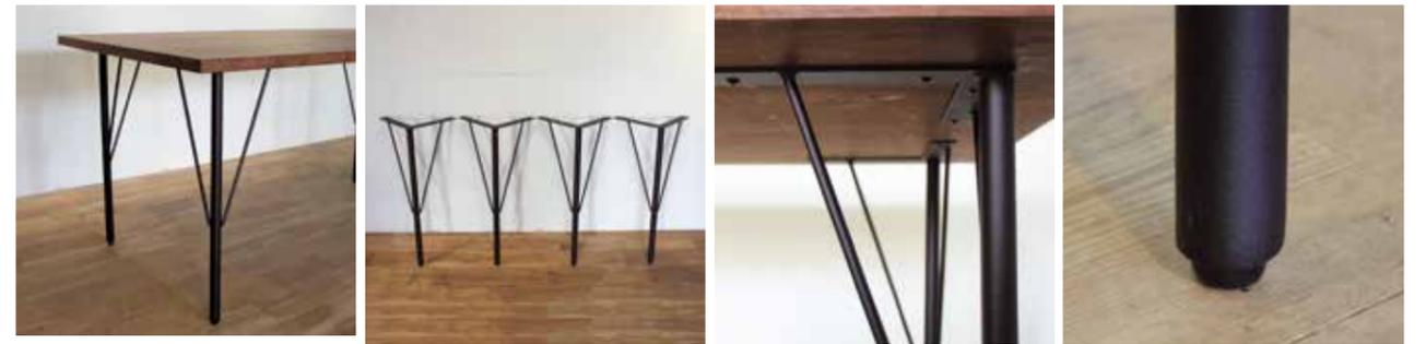
幅広いサイズの天板に対して取付位置で脚間の調整が可能となっています。φ27.2の丸パイプを使用し、筋交いを補強でいれることで安定感を得ています。
